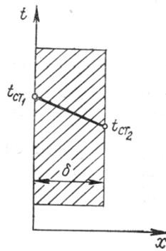
**Рис. 2.** К выводу уравнения теплопроводности плоской стенки
