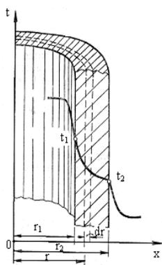
**Рис. 3.** К выводу уравнения теплопроводности однослойной цилиндрической стенки
